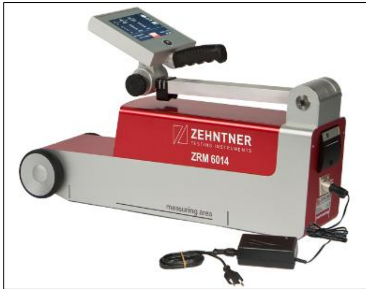
Slika 12. Reflektometar za statičko ispitivanje retrorefleksije oznaka ZRM 6014
