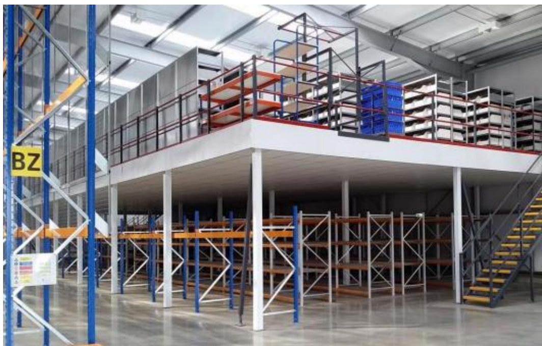
Slika 2. Primjer katnog (etažnog) skladišta
