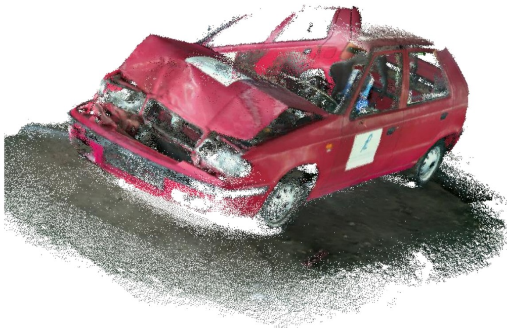
Slika 14. Prikaz 3D modela izrađen pomoću LiDAR kamere [10]
