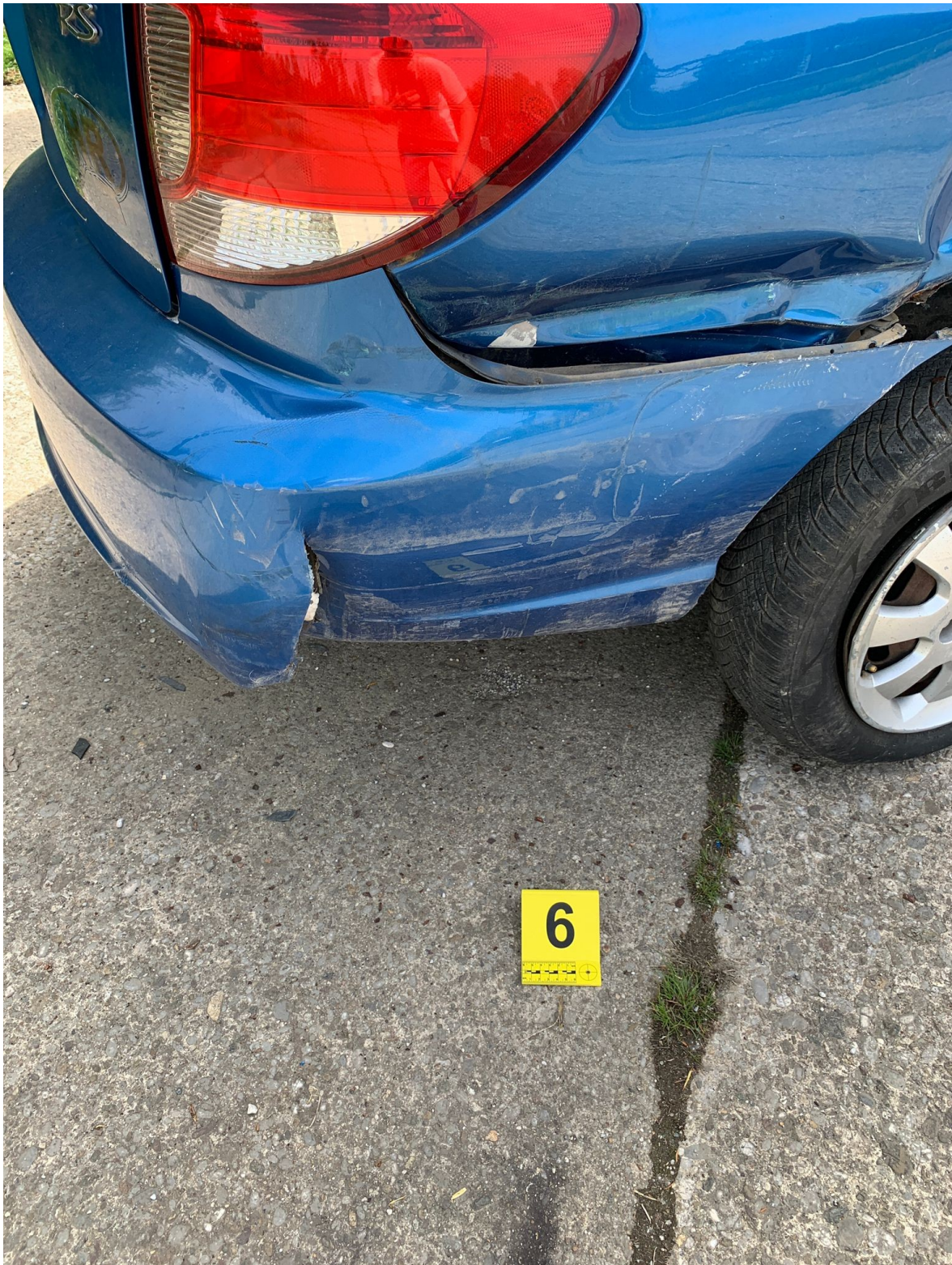
Slika 21. Prikaz deformacije bočnog dijela automobila Kia Rio RS
