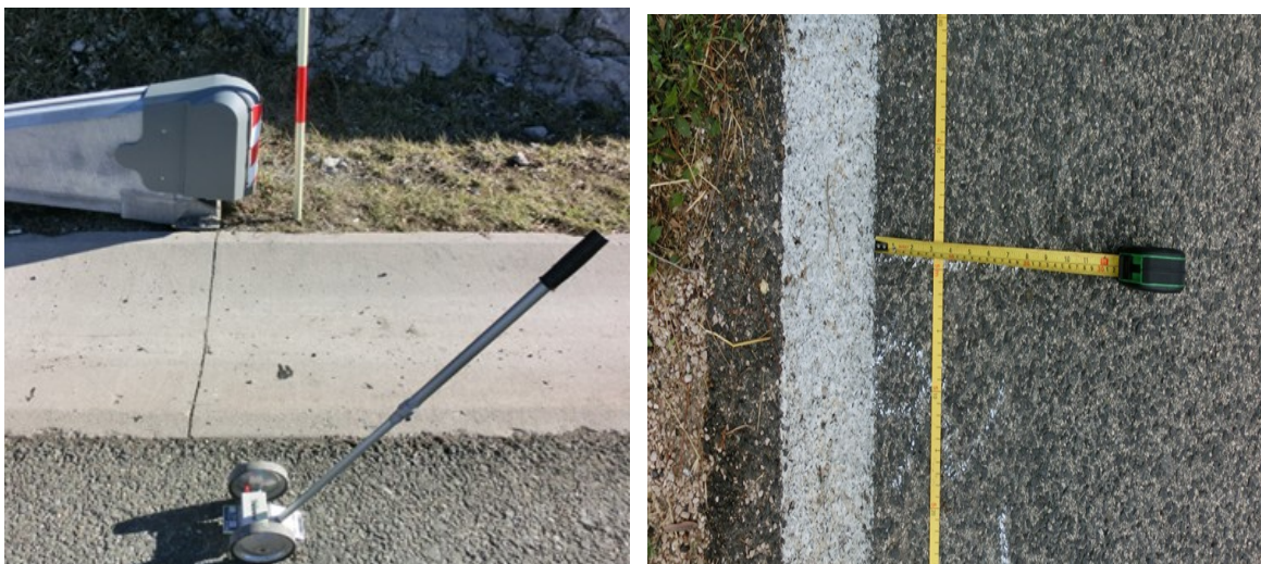
Slika 3. Prikaz mjernih kolica (lijevo) i metra (desno)
