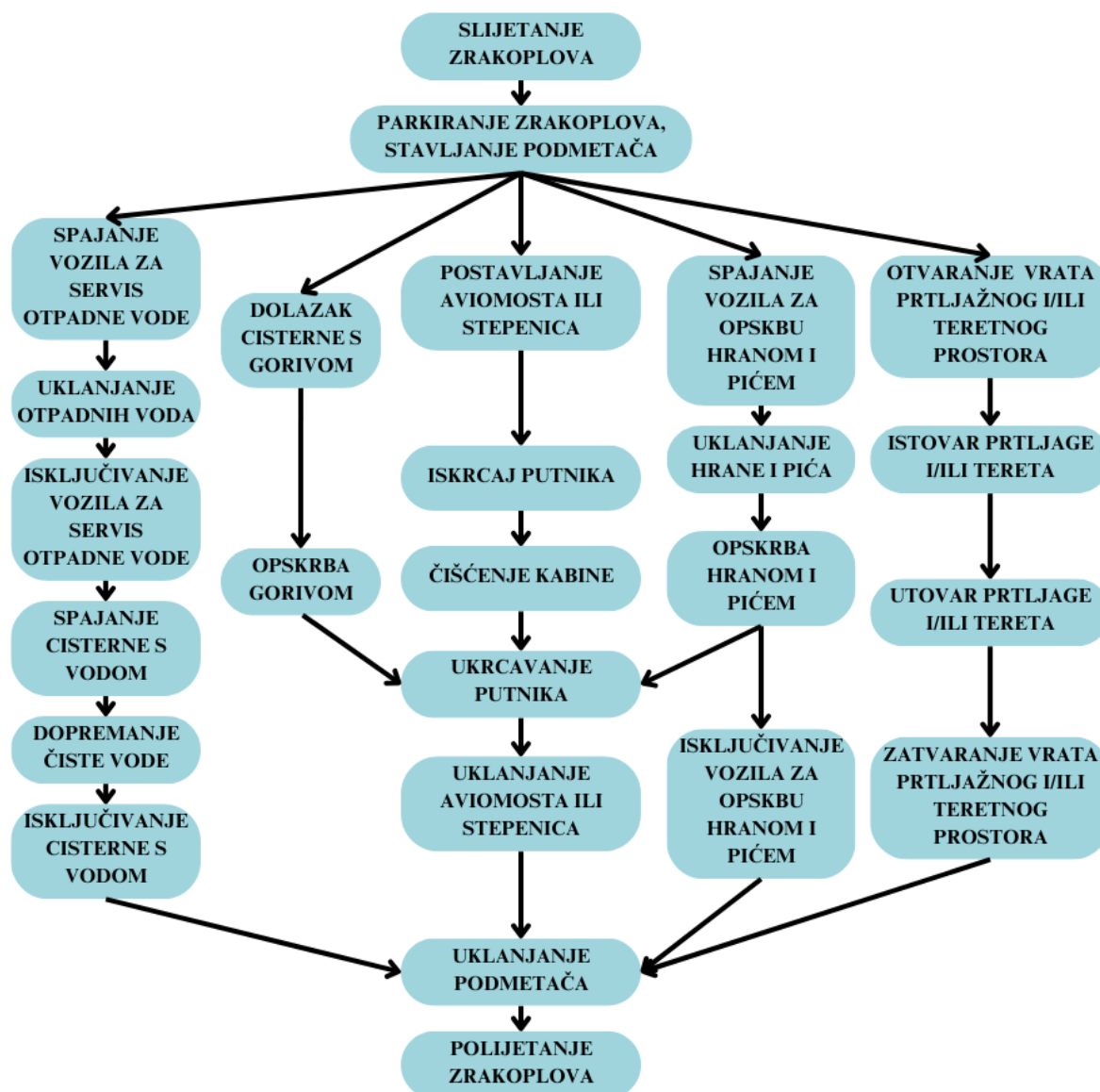
Slika 7. Prikaz sheme dijela procesa u zračnim lukama koji se odnose na prihvat i otpremu zrakoplova.
