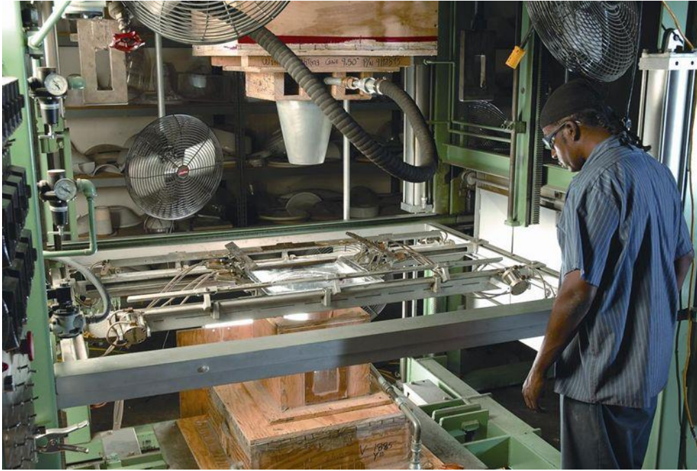
Slika 16: Prikaz termooblikovanja kao proces proizvodnje plastike Izvor: [27] https://plastic-domes-spheres.com/plastic-thermoforming/
