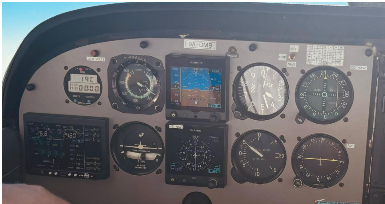
Slika 29. Instrumenti korišteni pri mjerenju: EDM, mjaerac temperature, brzinomjer, visinomjer
