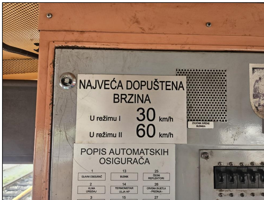
Slika 5. 1 . Najveće dopuštene brzine dizel manevarske lokomotive HŽ serije 2132-300
