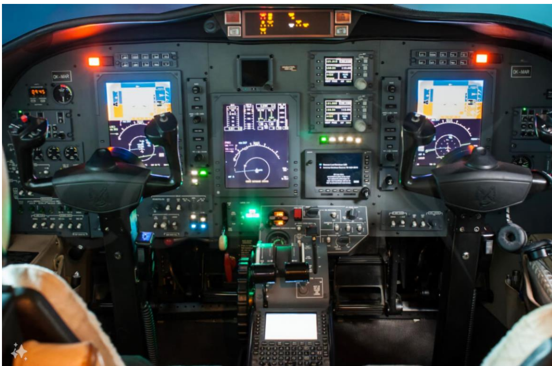
Slika 3.9. Upravljačnica Cessne 525 CJ2+
