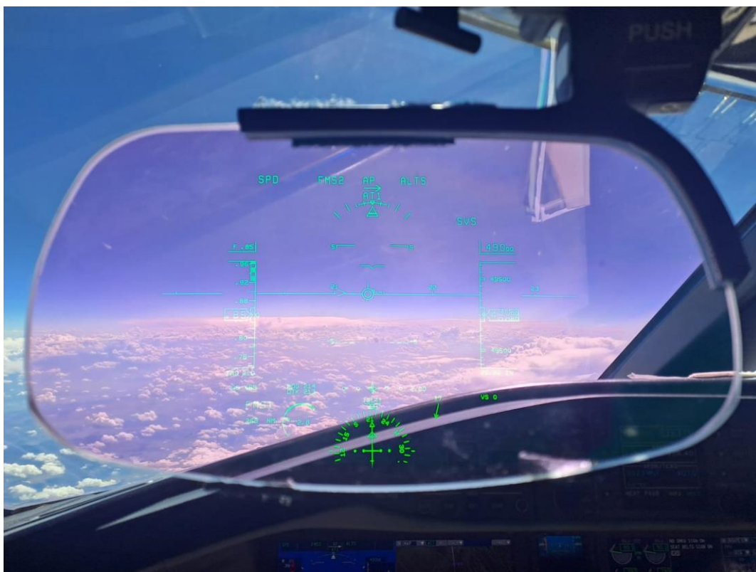
Slika 3.13 Zaslon za grupirane informacije zrakoplova Bombardier CL350
