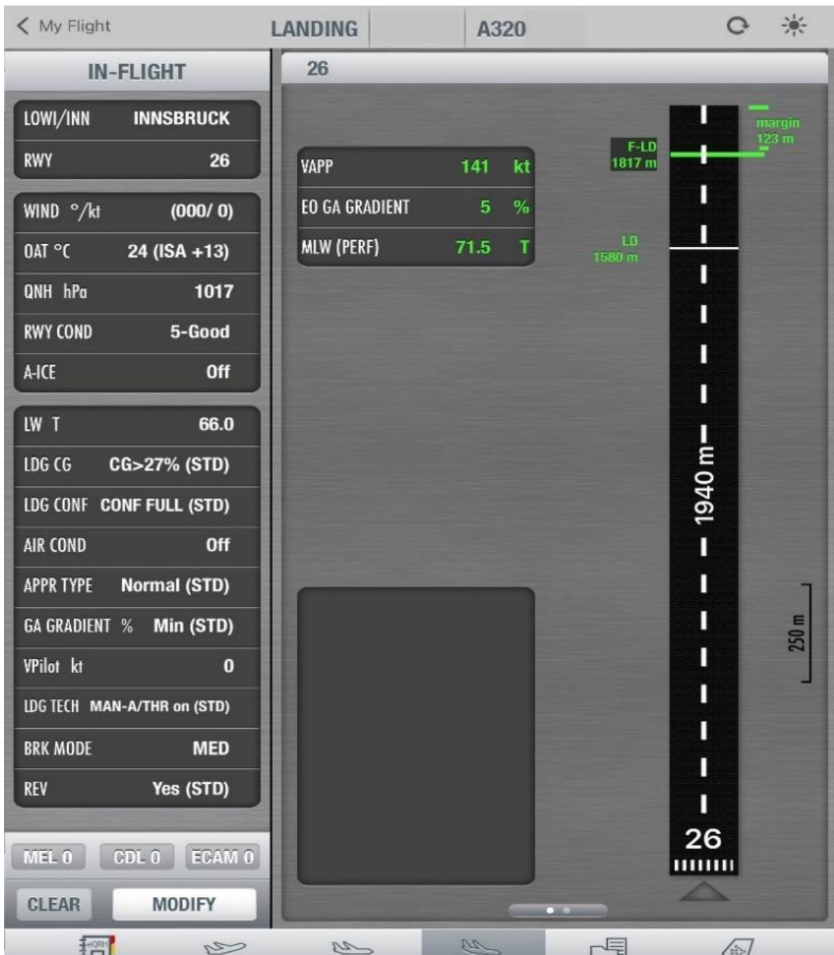
Slika 21. Izračun performansi na slijetanju - INN RWY 26 JUL
