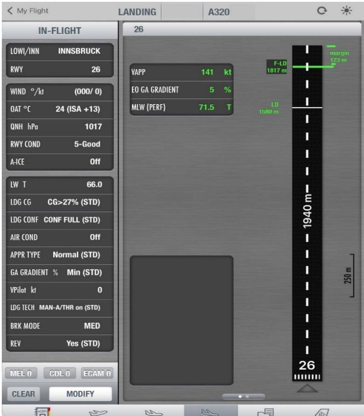
Slika 21. Izračun performansi na slijetanju - INN RWY 26 JUL
