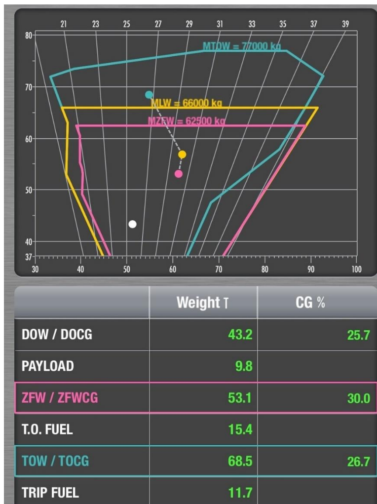
Slika 37. Prikaz pozicije centra težišta grafički i tablicom
