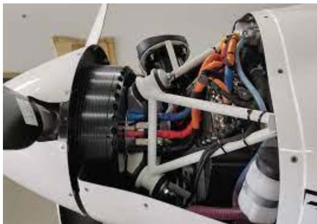
Slika 21. Pipistrel motor E-811 [27]
