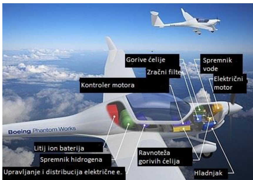
Slika 14. Sustav gorivih ćelija [19]
