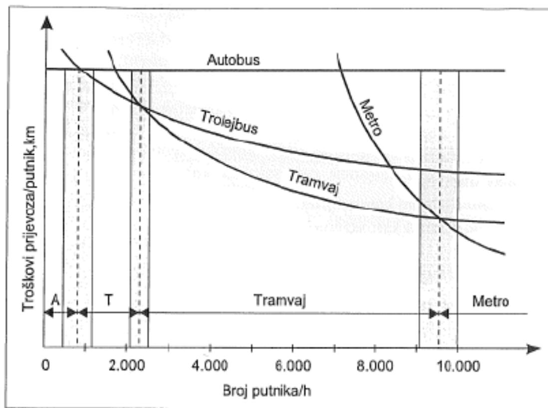
Slika 3. Opravdanost primjene pojedinih vrsta vozila
