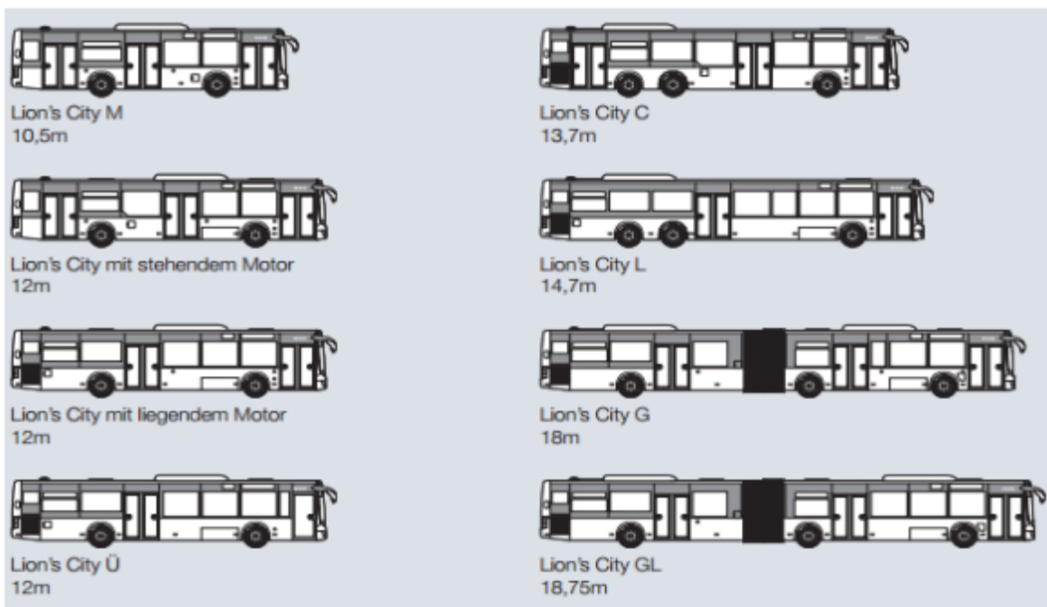
Slika 5. Različite konstrukcijske izvedbe autobusa gradskog tipa marke MAN
