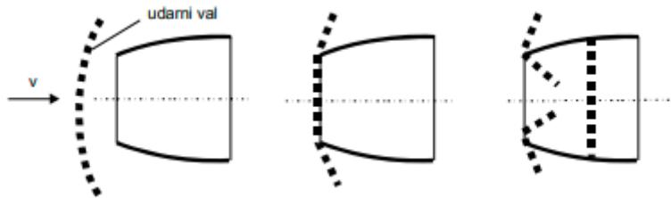
Slika 9. Promjena oblika udarnih valova sa promjenom brzine [3]
