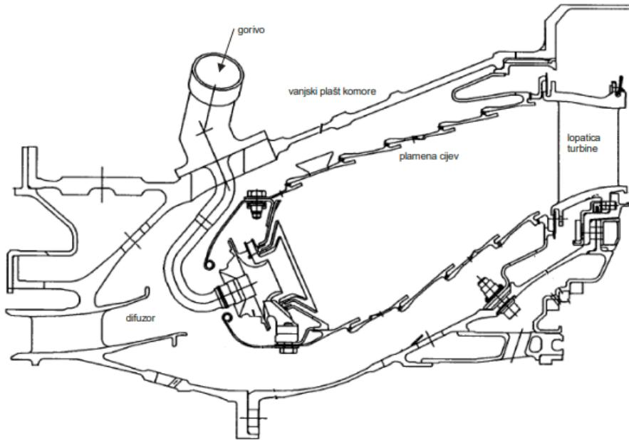
Slika 14. Primjer prstenaste komore izgaranja na motoru CFM56 [3]
