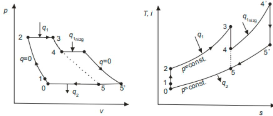
Slika 24. Idealni ciklus mlaznog motora s naknadnim izgaranjem [3]
