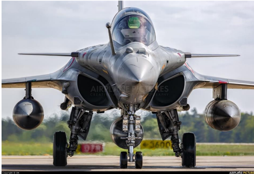
Slika 8. Bočni uvodnici na zrakoplovu Dassault Rafale [2]
