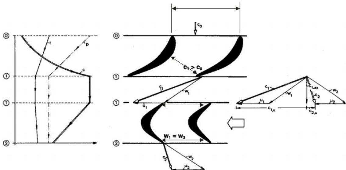
Slika 15. Akcijska turbina i promjena brzina
