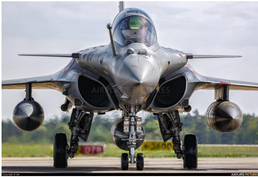
Slika 8. Bočni uvodnici na zrakoplovu Dassault Rafale [2]
