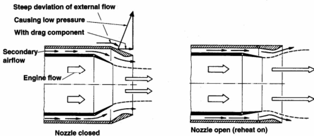
Slika 17. Konvergentno- divergentni mlaznik sa promjenjivom geometrijom [3]
