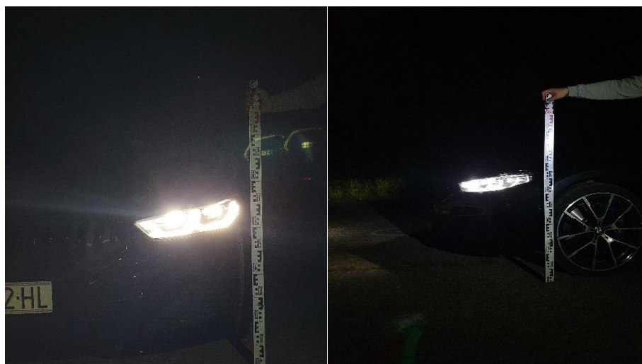
Slika 24. Visina svjetlosnog uređaja BMW
