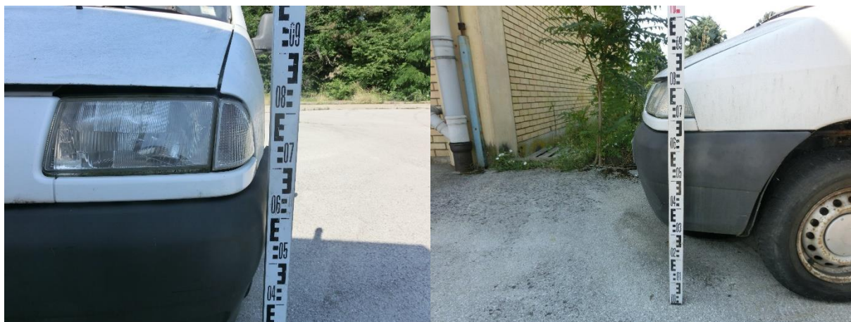
Slika 49. Visina svjetlosnog uređaja Fiat Scudo
