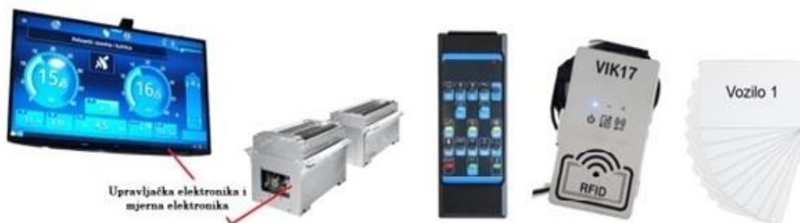
Slika 6. Uređaj za ispitivanje kočnica te njegovi dodatci (daljinski upravljač, RFID čitač i kartica). Izvor: [11]
