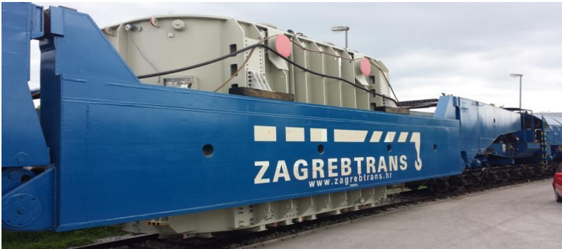
Slika 11. Kotao transformatora na industrijskom kolosijeku Končar Izvor: ZAGREBTRANS d.o.o. 2022.
