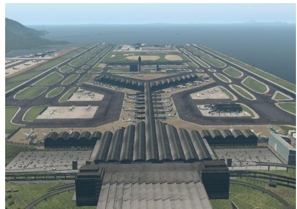
Slika 8. Fingerska konfiguracija, Y-tip Zračna luka Hong Kong, Kina, [23]
