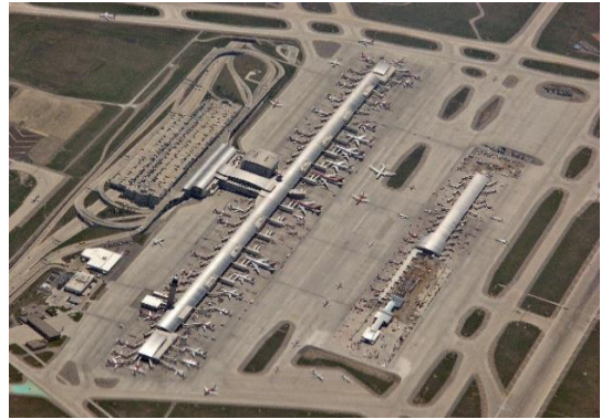
Slika 4. Linearna konfiguracija Zračna luka Detroit, SAD, [19]
