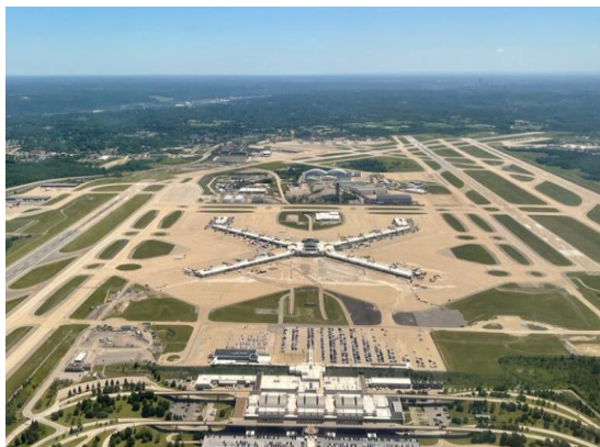
Slika 7. Fingerska konfiguracija, X-tip Zračna luka Pittsburgh, SAD, [22]
