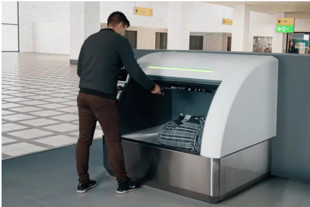
Slika 27. "CrisBag" - sustav samopredaje prtljage, [58]
