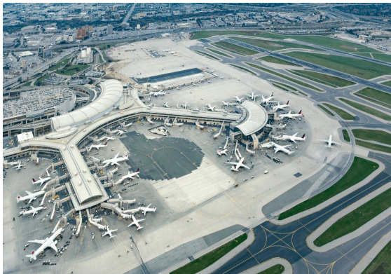
Slika 5. Fingerska konfiguracija Zračna luka Toronto, Kanada, [20]
