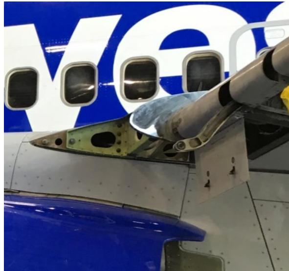
**Slika 5.** Oštećenje krila zbog udara ptice
