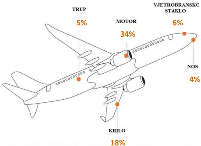
**Slika 3.** Postotak udara ptica u određene dijelove zrakoplova
