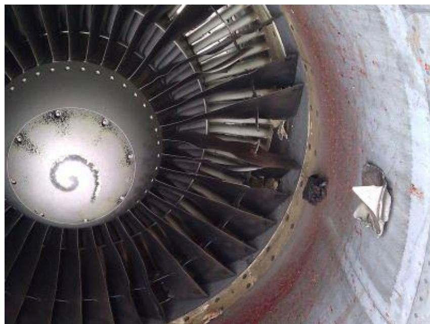
**Slika 4.** Oštećenje lopatica ventilatora
