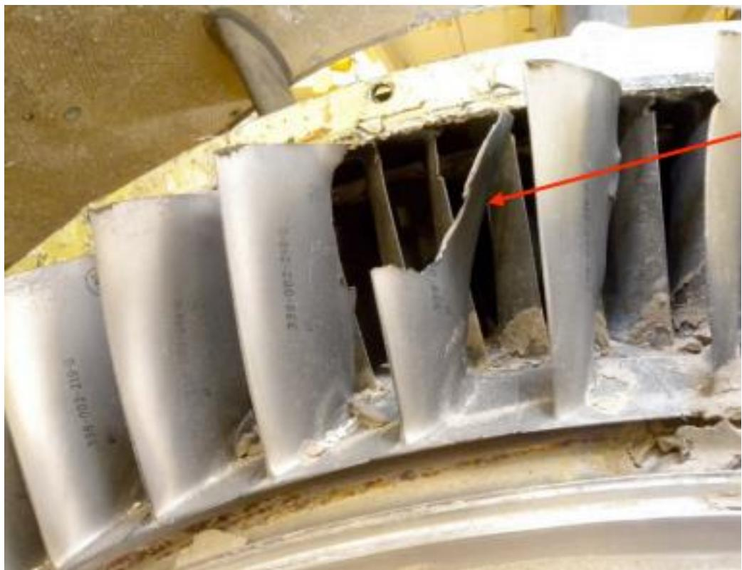
**Slika 10.** Prikaz oštećenog motora s leta 1549
