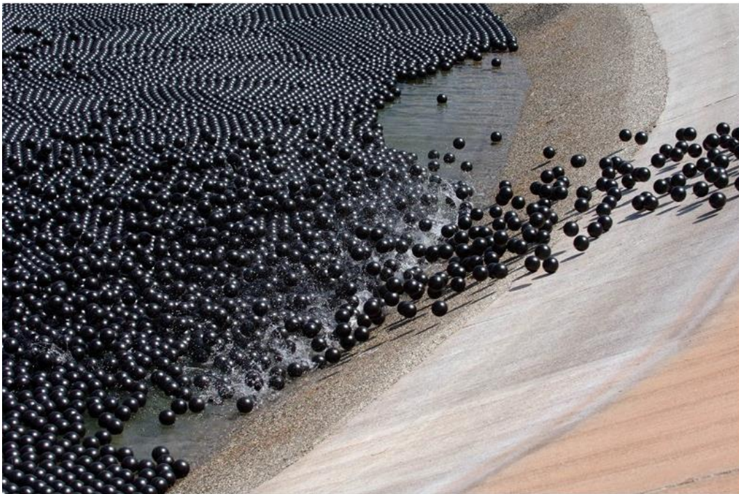
Slika 15. Prikaz plutajućih lopti
