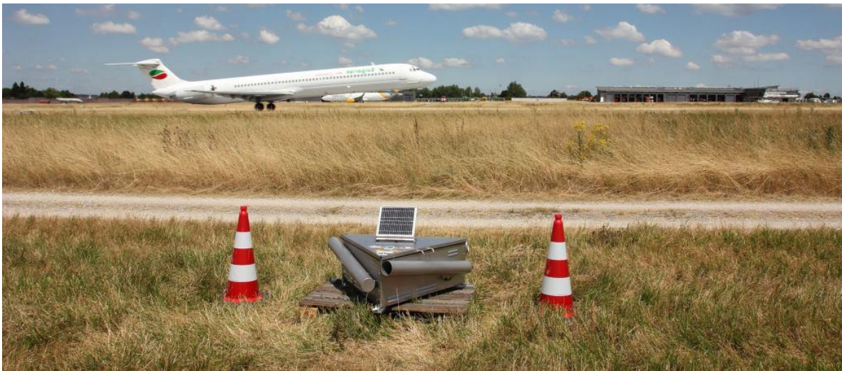
Slika 18. Prikaz plinskih topova
