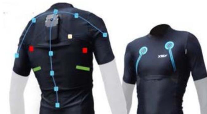
Slika 9. Nosivi sustav za otkrivanje pospanosti
