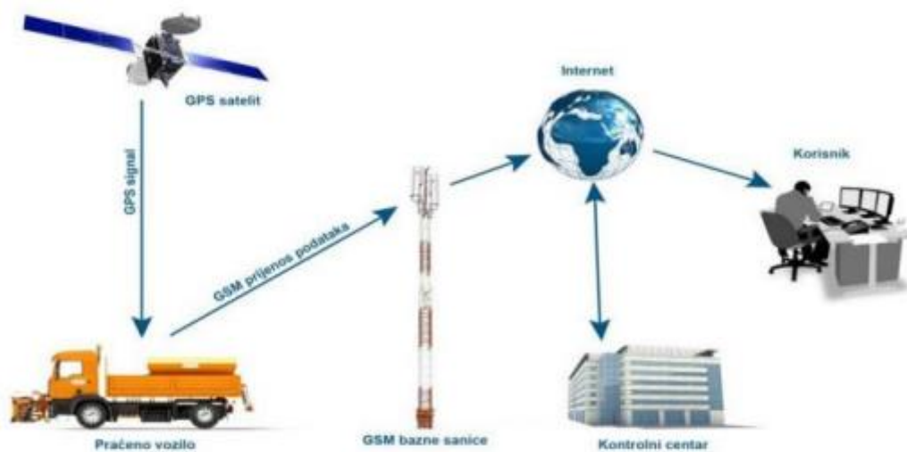
Slika 10. Praćenje vozila primjenom GPS i GPRS tehnologije
