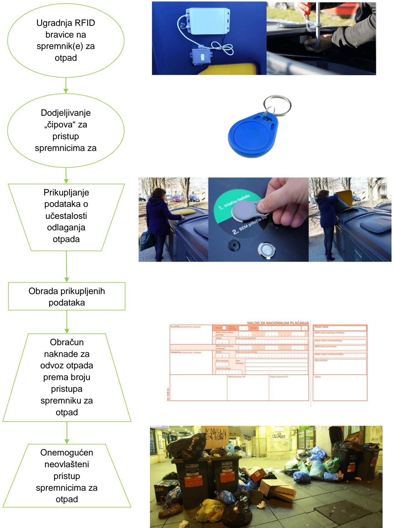
Slika 21: dijagram toka upotrebe RFID bravice za kontrolirani pristup spremnicima za otpad
