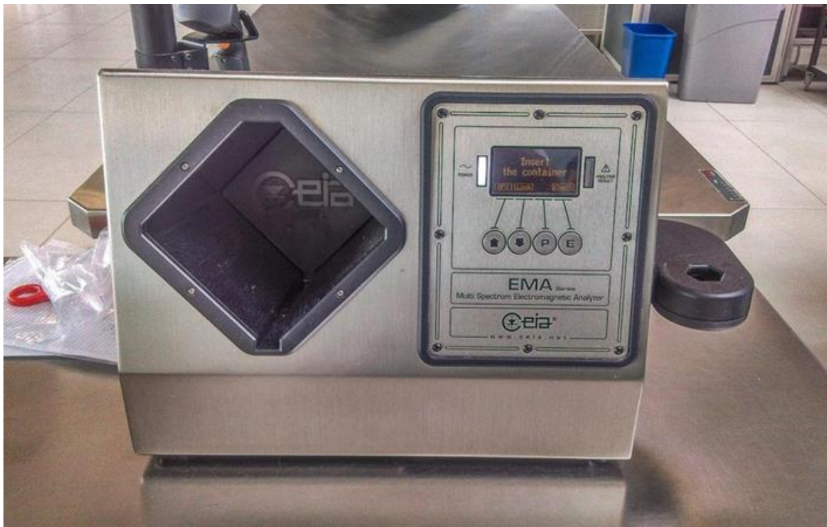
Slika 18. Uređaj za pregled tekućina, raspršivača i gelova
