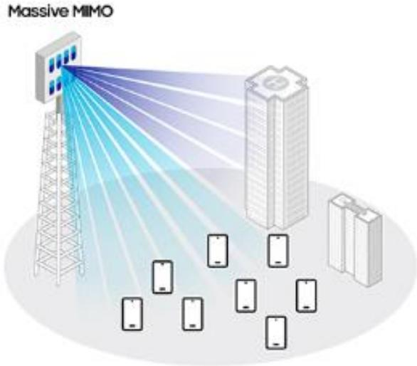
**Slika 3. MIMO tehnologija- prikaz emitiranja signala**
