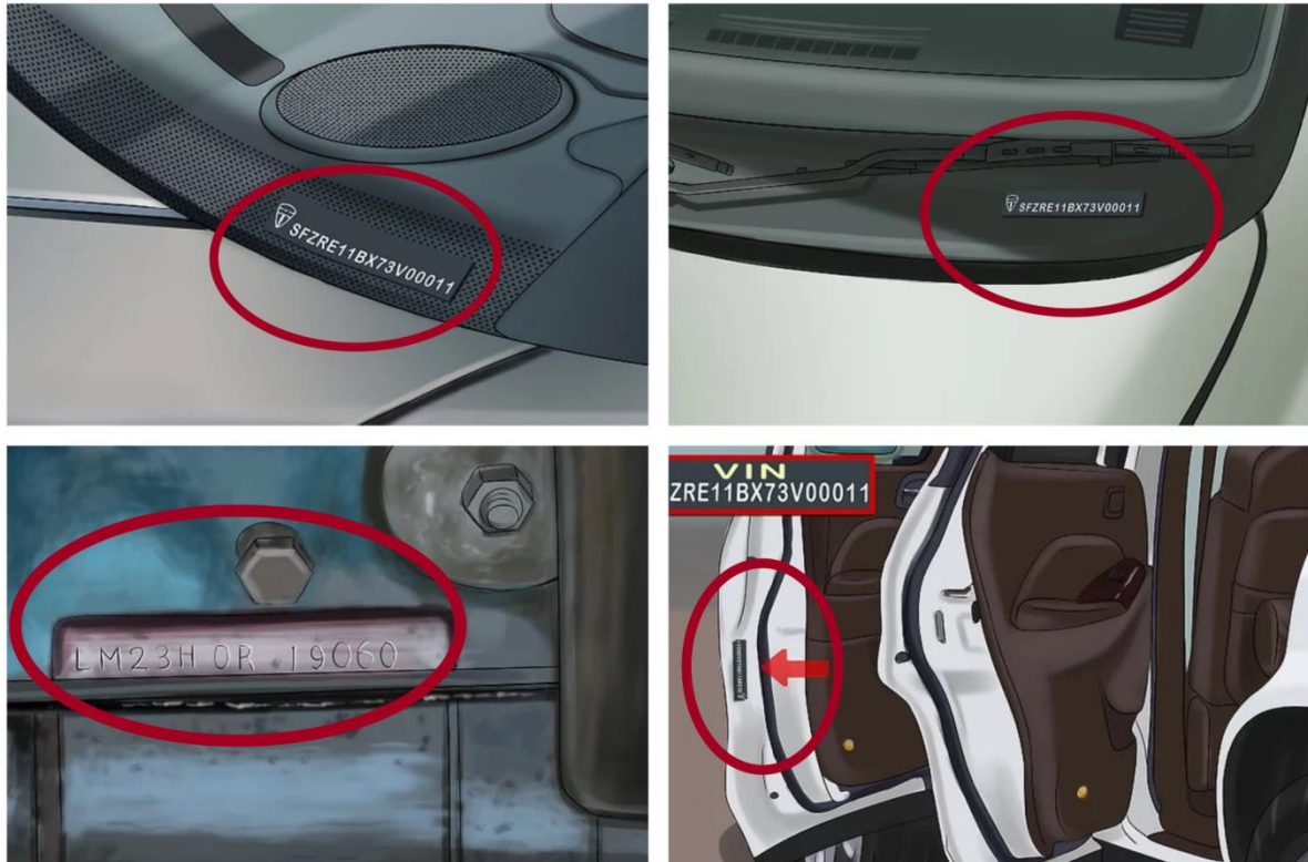
Slika 17. Lociranje oznake VIN na vozilu
