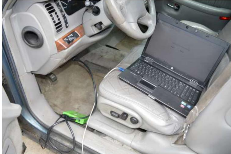
Slika 21. Princip rada metode Direct To Link
