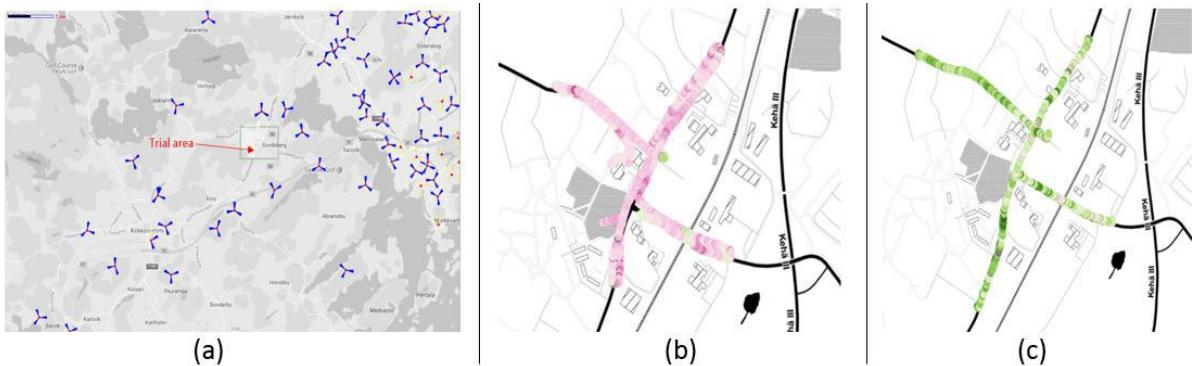
Slika 11. Testni let drona u Masali, Finska: a) prikaz pozicija baznih stanica i orientacija antena oko testnog područja; b) prikaz rute za letjelicu na 2D karti; c) prikaz referentne rute po kojoj se kretao automobil na zemlji.
