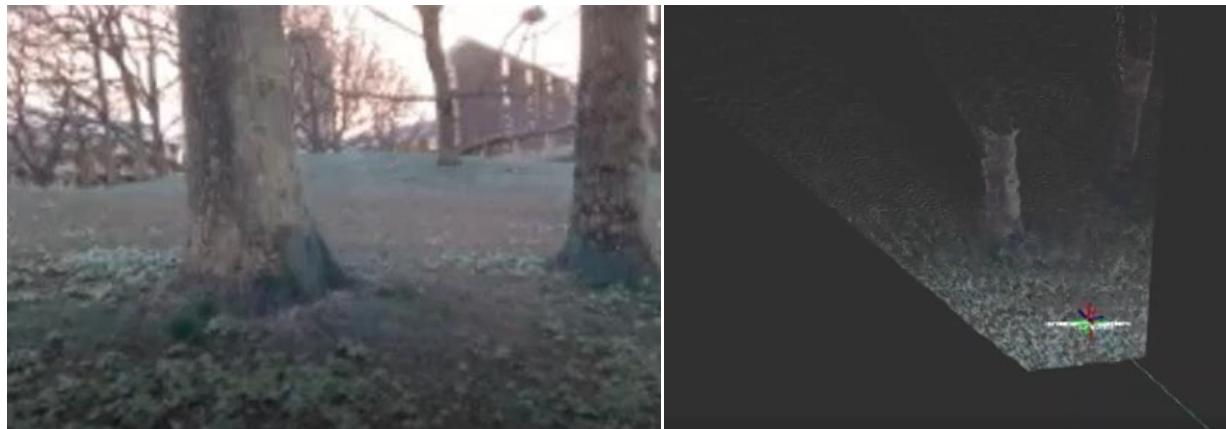
Slika 21. Prikaz korištenja RGBD kamere za detekciju prepreke.
