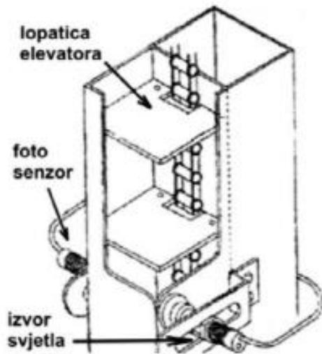
Slika 13. Princip mjerena obujma žitarice, [45]
