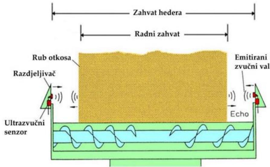
Slika 14. Shema adaptera sa ultrazvučnim senzorima, [48]
