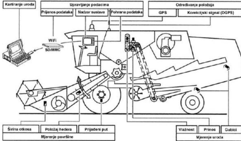
Slika 12. Shema sustava za određivanje prinosa, [45]
