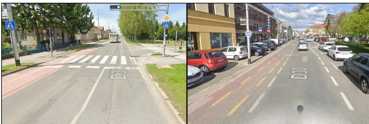
Slika 13. Prikaz jednostrane dvosmjerne biciklističke trake Izvor: autor uz korištenje „Google karte“
