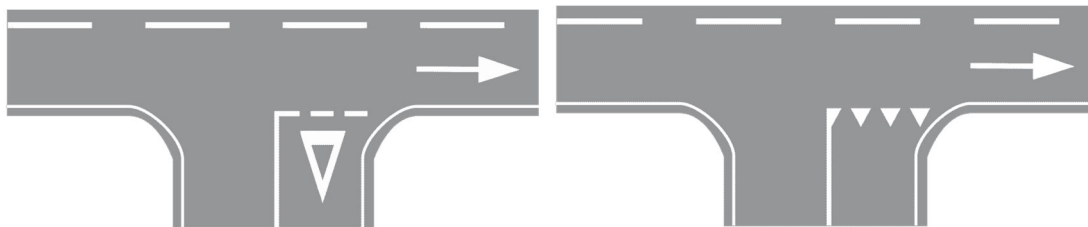
Slika 22. Isprekidana crta zaustavljanja sa iscrtanim trokutom upozorenja ispred nje ili zamijenjena trokutima vrhom okrenutim prema vozilu
