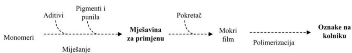
Slika 7. Shema procesa izvođenja termoplastike [signalizacija]
