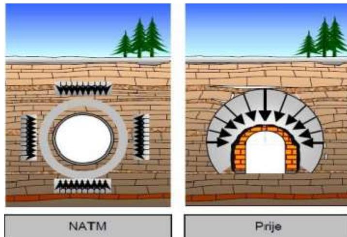
Slika 17. Nova metoda izgradnje tunela[18]
