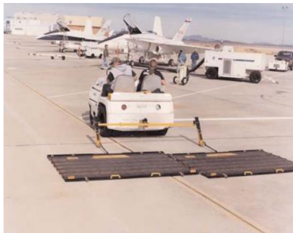
Slika 15. Prostirka za uklanjanje FOD-a, [10]
