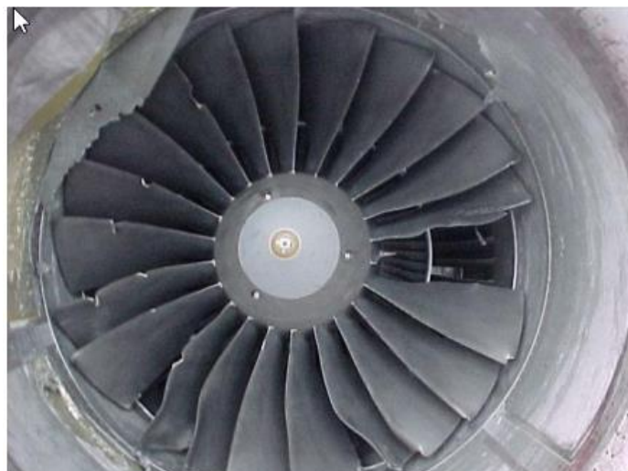
Slika 3. Oštećenje motora zrakoplova prilikom udara ptice, [7]
