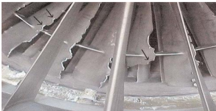
Slika 7. Oštećenje lopatice zrakoplova, [10]
