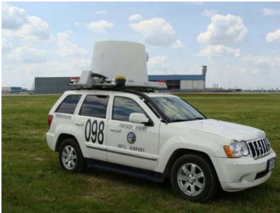
Slika 10. Mobilni sustav radarske detekcije, [11]
