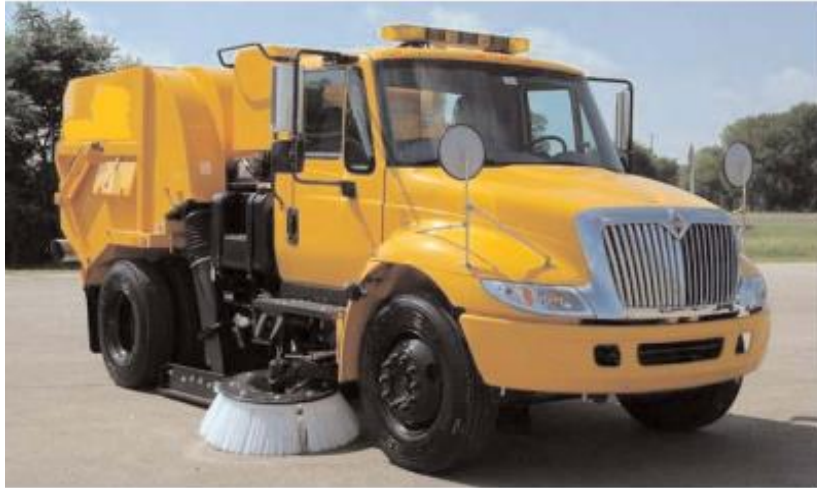
Slika 18. Vozilo s četkom i vakuumskim sustavom, [10]
