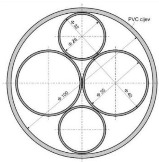
Slika 2. Odnos cijevi velikog promjera i cijevi promjera 50 mm
