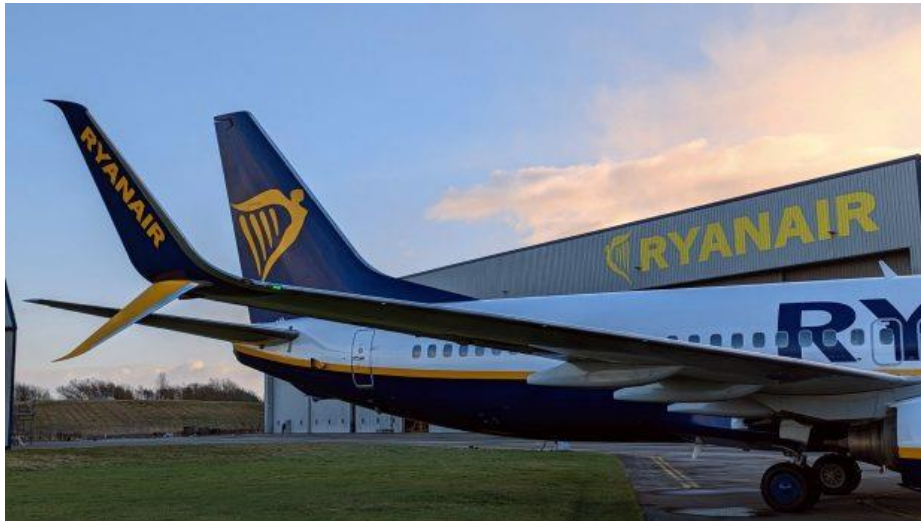
Slika 5. razdvojeni završetak krila (engl. Split Scimitar Winglet), [7]
