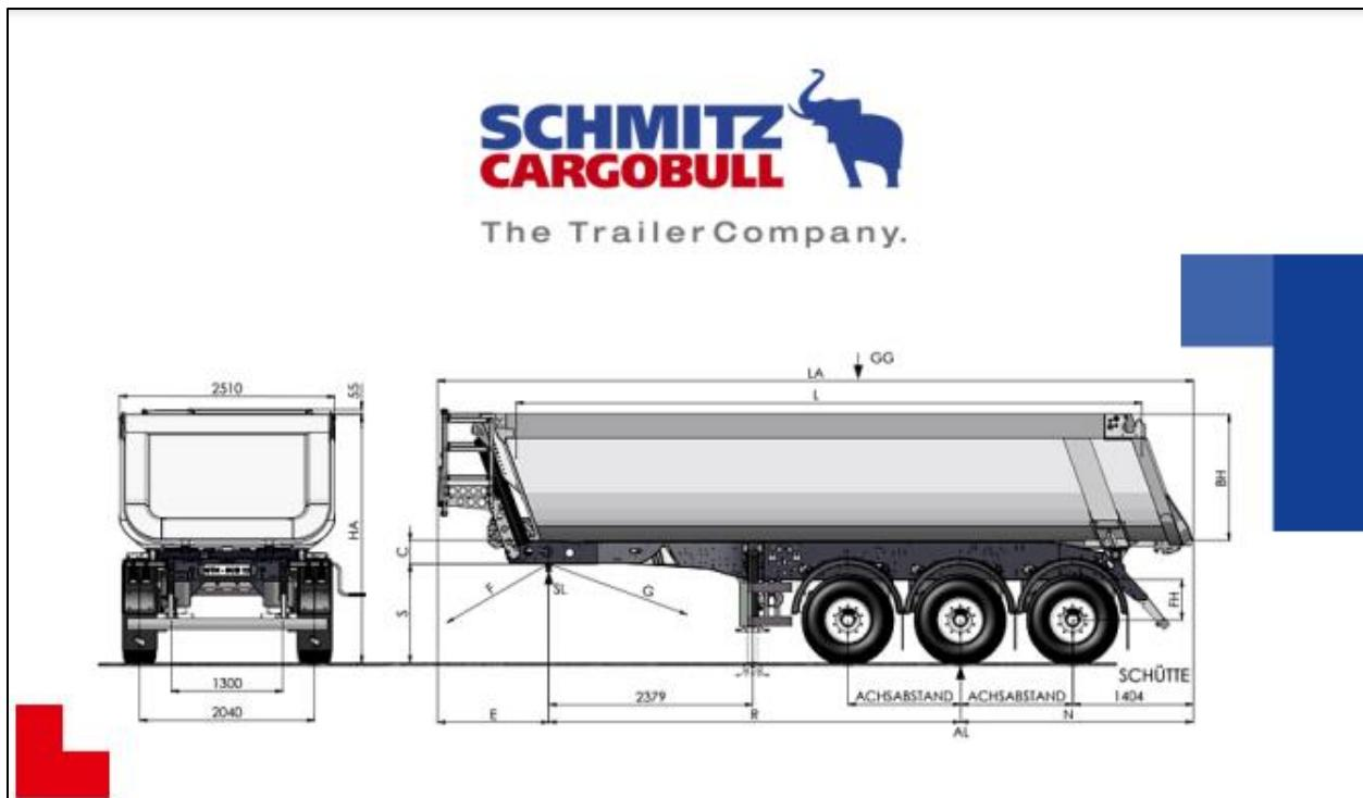
Slika 45. Dimenzijske mjere troosovinske poluprikolice kiper konstrukcije SCHMITZ proizvođača marke S.KI SOLID prikazane tehničkim crtežom važne za eksploraciju, [53]
