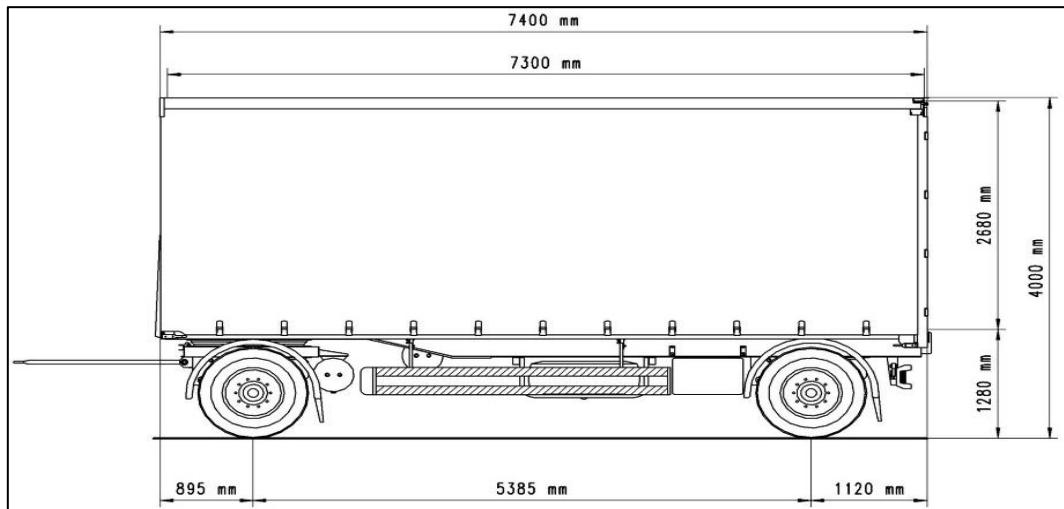
Slika 13. Dimenzijske mjere dvoosovinske prikolice s ceradom od SCHWARZMÜLLER proizvođača marke STANDARD prikazane tehničkim crtežom važne za eksploraciju, [13]
