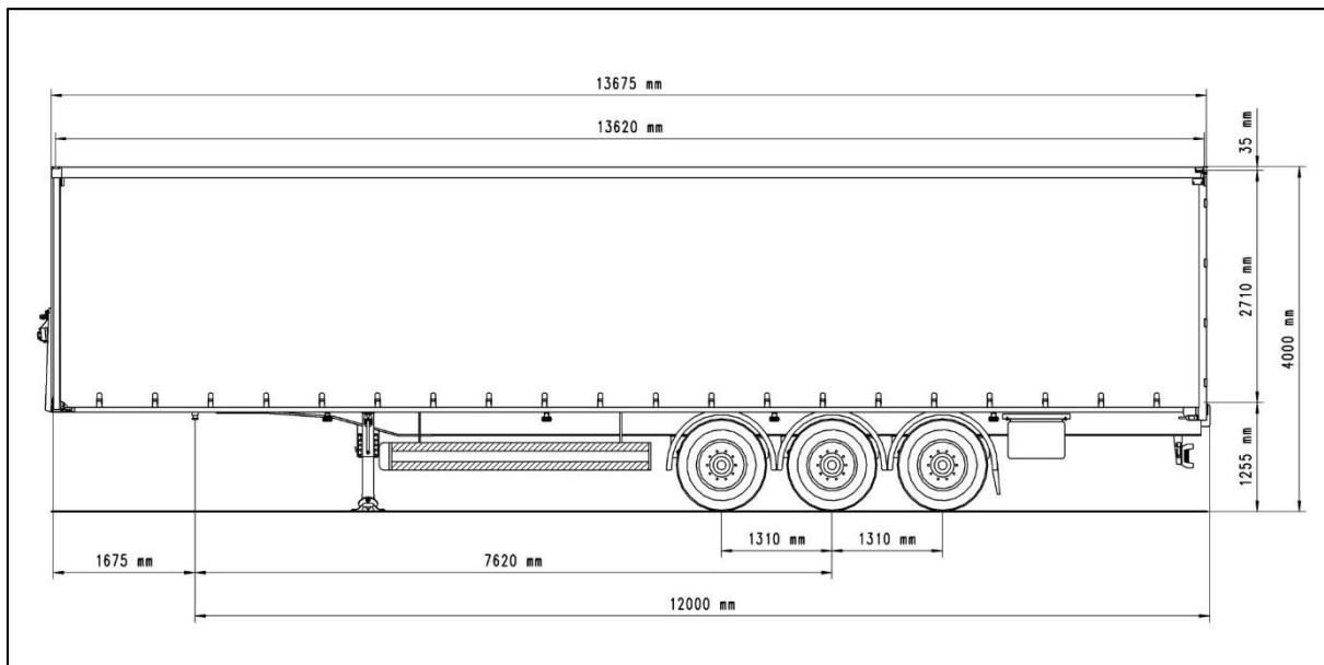
Slika 20. Dimenzijske mjere troosovinske poluprikolice s ceradom SCHWARZMÜLLER proizvođača marke POWER LINE prikazane tehničkim crtežom važne za eksploraciju, [43]
