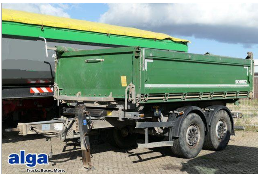
Slika 42. Vanjski izgled dvoosovinske prikolice kiper konstrukcije SCHMITZ proizvođača marke Z.KI s mogućnošću stražnjeg i bočnog podizanja utovarnog prostora, [23]
