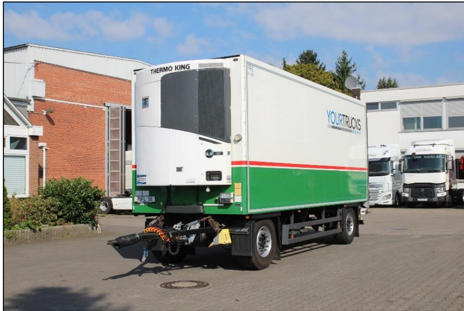
Slika 32. Vanjski izgled dvoosovinske prikolice s temperaturnim režimom rada SCHMITZ proizvođača marke A.KO koja ima ugrađeni rashladni uređaj THERMO KING, [19]
