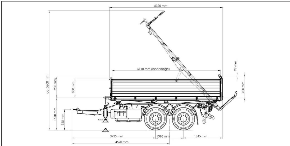
Slika 39. Dimenzijske mjere dvoosovinske prikolice kiper konstrukcije SCHWARZMÜLLER proizvođača prikazane tehničkim crtežom važne za eksploraciju, [51]
