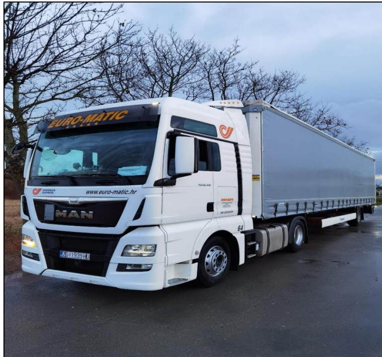
Slika 48. Prikaz jednoosovinske poluprikolice KRONE Profi Liner vučene tegljačem marke MAX TGX, [55]
