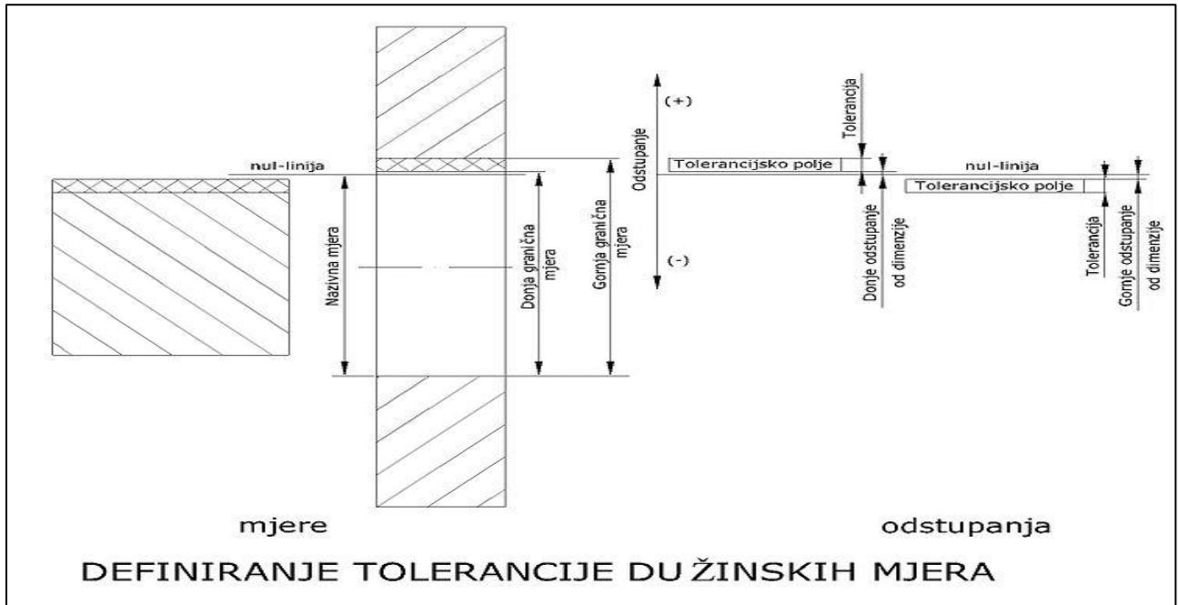
Slika 11. Tehnički crtež osovine i prvrta s prikazom nazivne mjere, gornjeg i donjeg odstupanja i ostalih dužinskih mjera koje su važne prilikom konstruiranja i upotrebe istog, [8]
