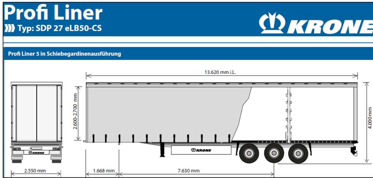
Slika 30. Dimenzijske mjere troosovinske poluprikolice s ceradom KRONE proizvođača marke Profi Liner prikazane tehničkim crtežom važne za eksploraciju, [50]
