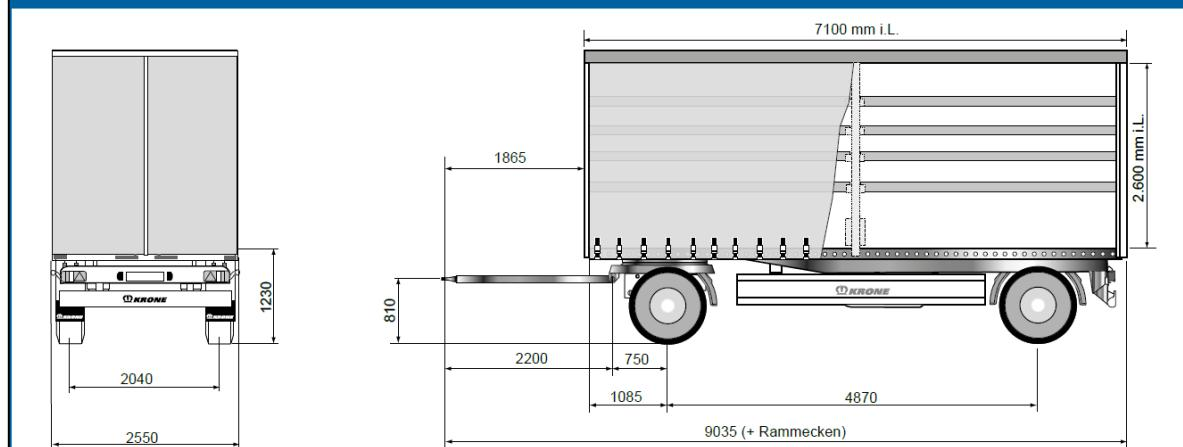
Slika 18. Dimenzijske mjere dvoosovinske prikolice s ceradom KRONE proizvođača marke Profi Carrier prikazane tehničkim crtežom važne za eksploataciju, [41]
