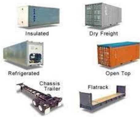
Slika 2: Intermodalne transportne jedinice 5
