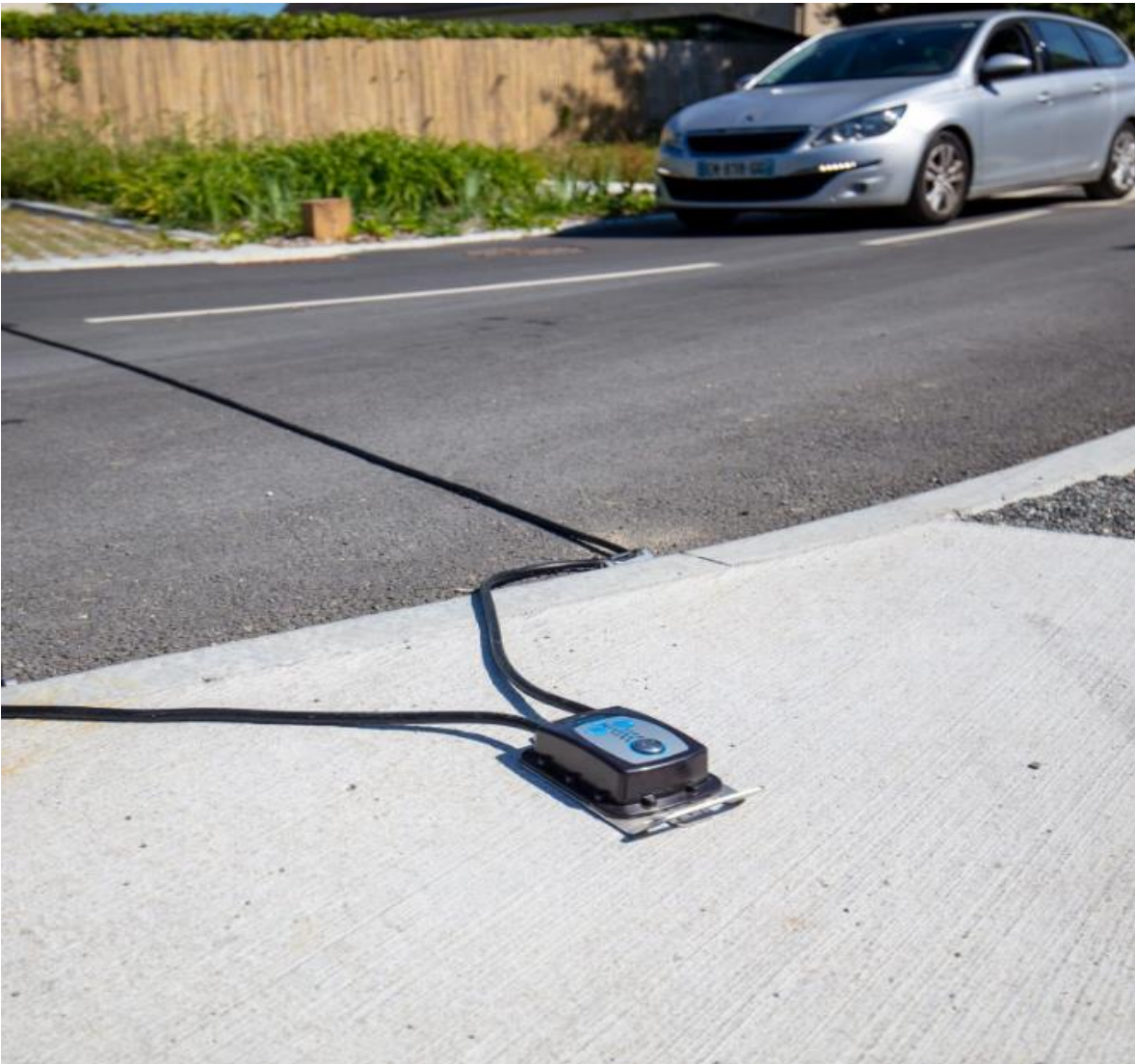
Slika 15. Pneumatsko brojilo Izvor: [7]
