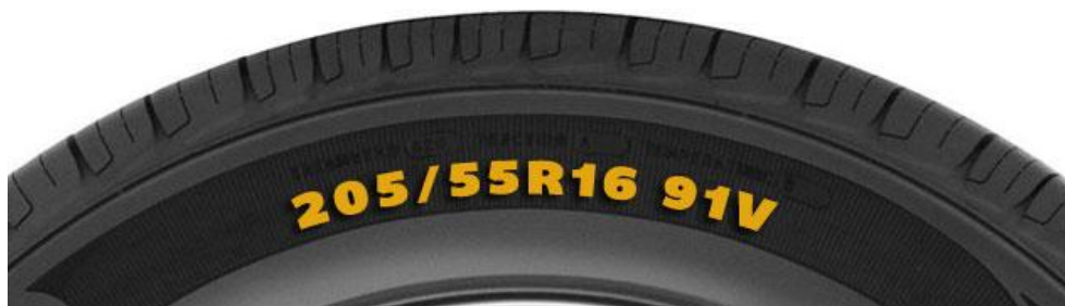
Slika 15. Oznake na pneumatiku
