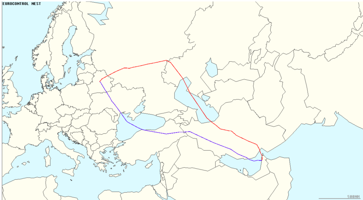
Slika 59. Putanja leta zrakoplova FDB1716 prije (plavo) i nakon (crveno) zatvaranja zračnog prostora Ukrajine [18].
