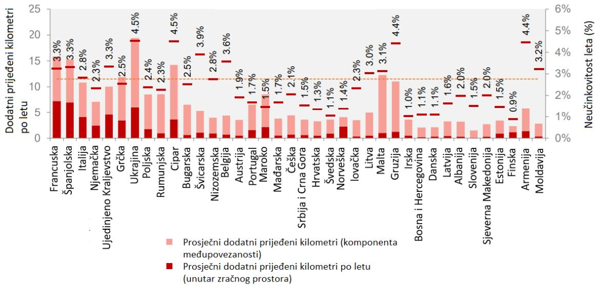
Slika 22. Horizontalna en-route efikasnost stvarne treajektorije rastavljena na komponente po državama članicama EUROCONTROL-a [23].
