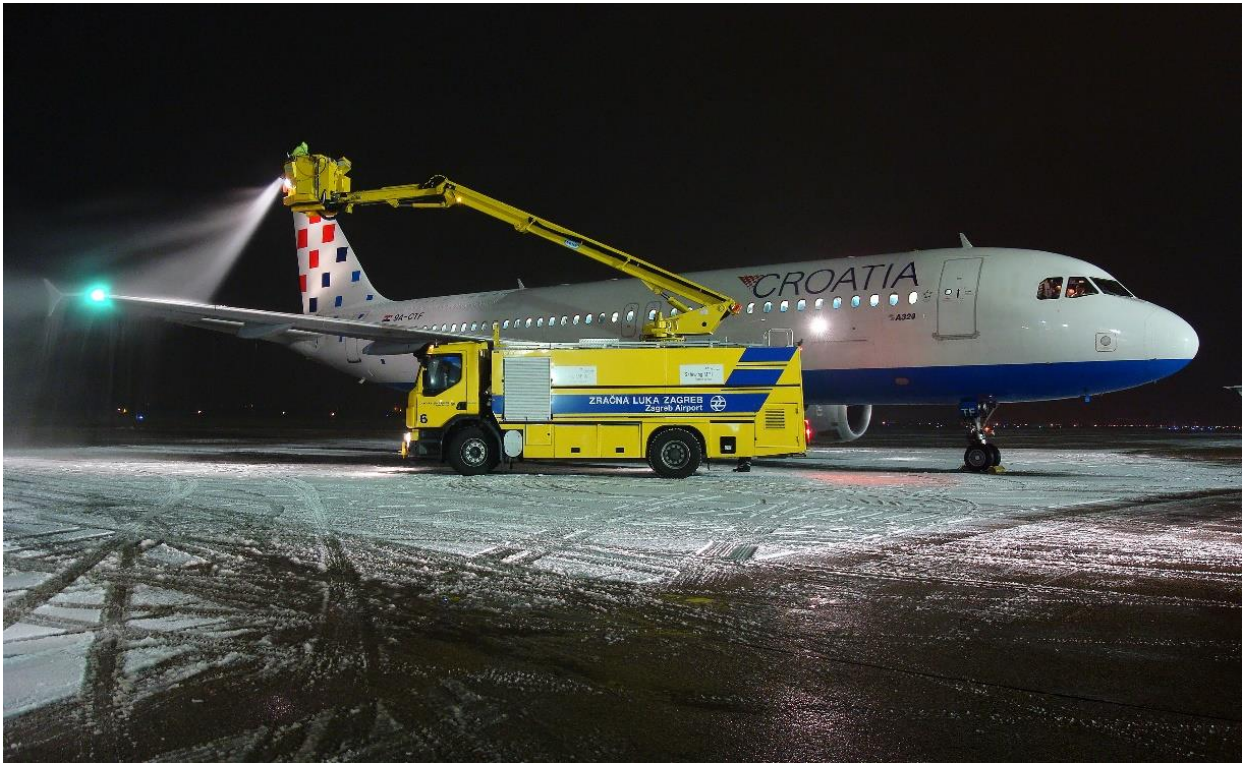
Slika 4. Tekući (kemijski) način zaštite od zaleđivanja
