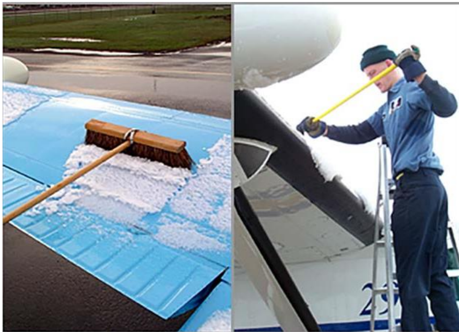
Slika 7. Mehaničko skidanje snijega metlom
