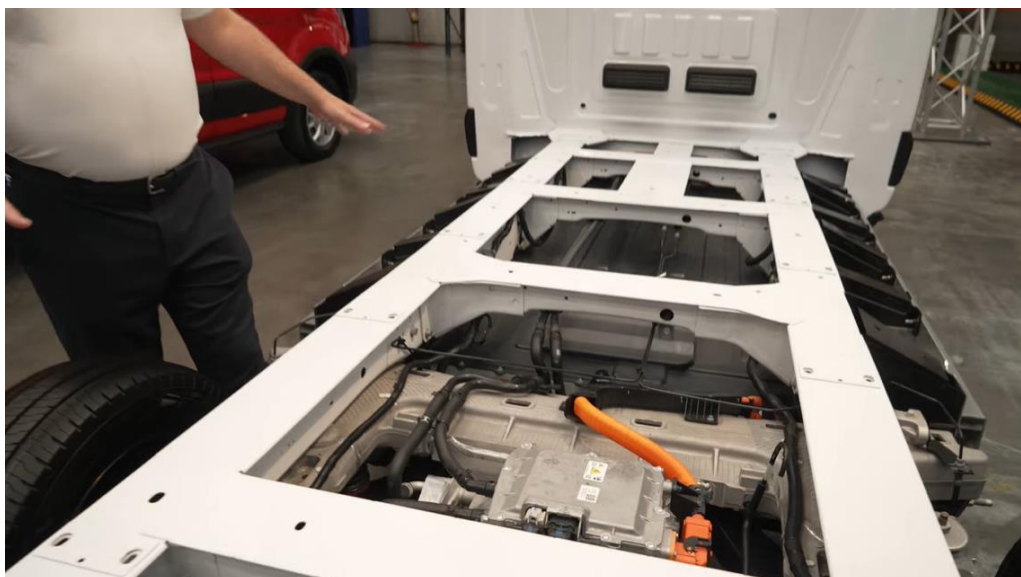
Slika 25. Pogonski sklop Ford E-Transita
