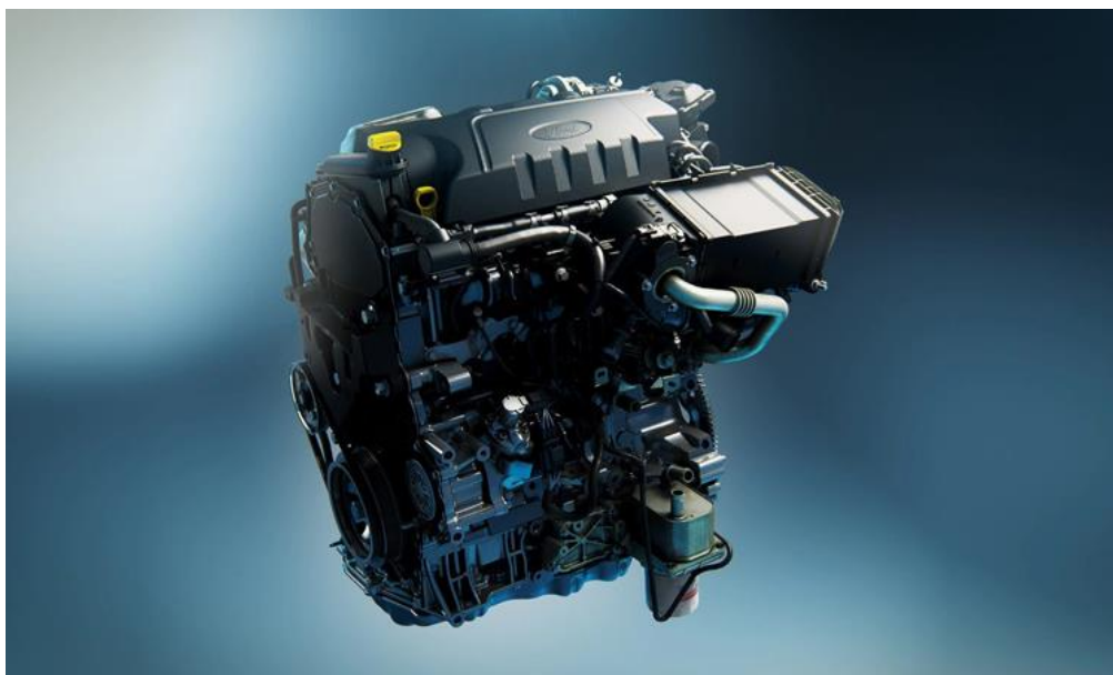
Slika 14. Dizelski motor 2.0 EcoBlue Ford Transita
