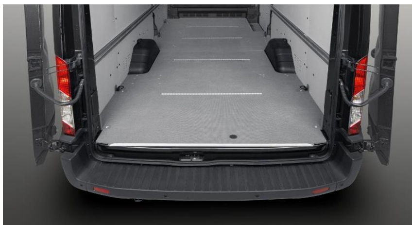
Slika 15. Utovarni prag na stražnjem braniku Ford Transita
