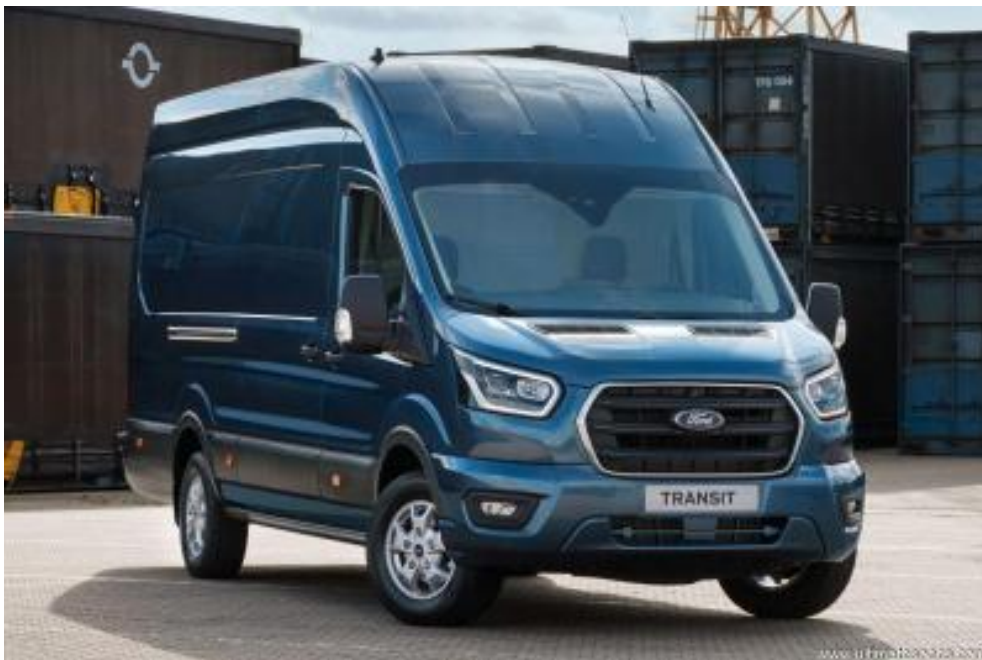
Slika 13. Ford Transit furgon u izvedbi L3H2 dužini i visini
