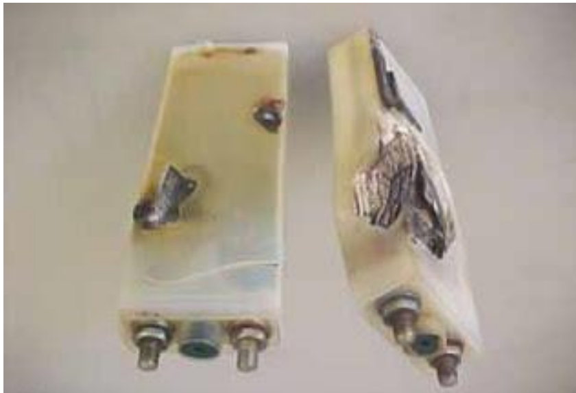
Slika 8. Nepovratna šteta učinjena termalnim bijegom, [12]
