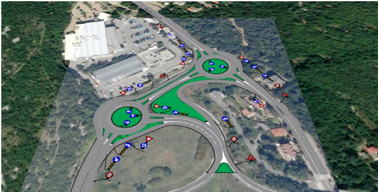
Slika 44. Varijantno rješenje 1 - kružni tok u programskom alatu PTV Vissim
