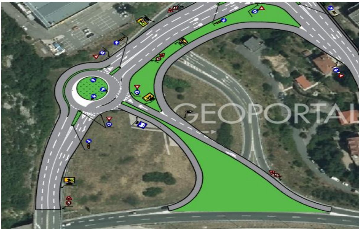
Slika 42. Drugo turbo kružno raskrižje
