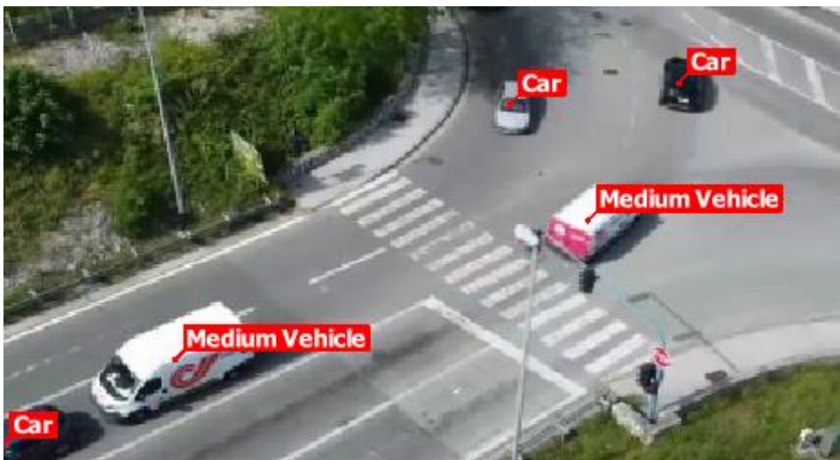
Slika 32. Prikaz klasifikacija vozila
