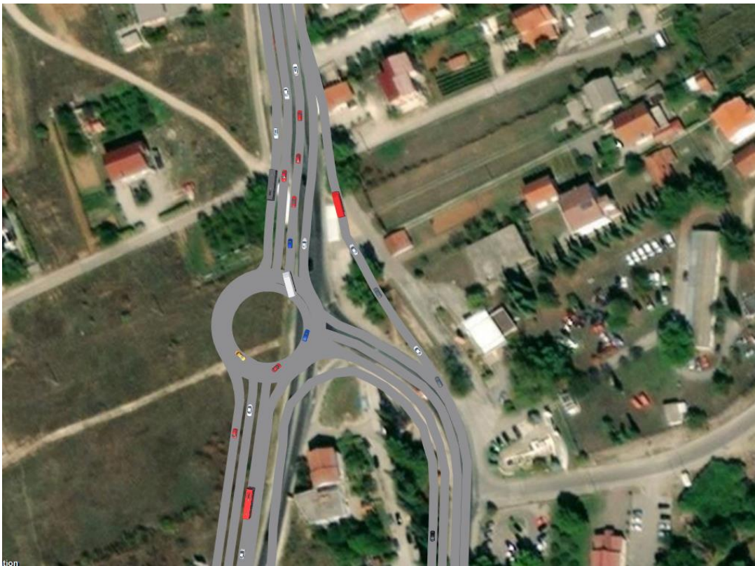
Slika 19. Prikaz idejnog rješenja 2 u programskom alatu PTV Vissim
