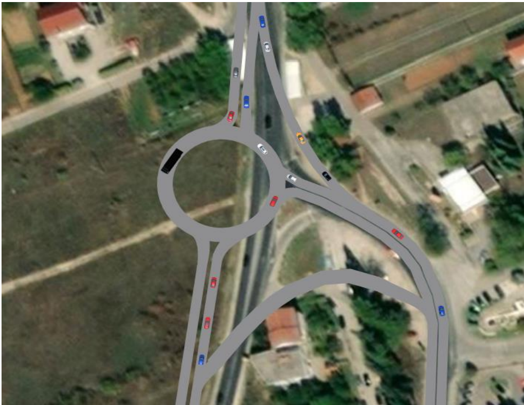
Slika 18. Prikaz idejnog rješenja 1 u programskom alatu PTV Vissim
