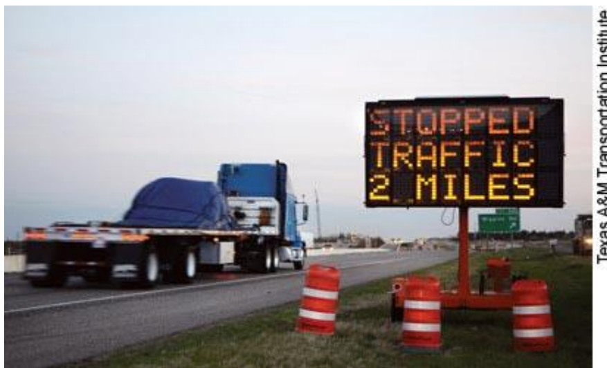
Slika 36: Inteligentni promjenjivi prometni znak sa sensorom
