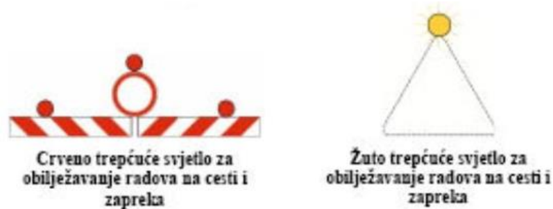
Slika 25: Prometna svjetla za obilježavanje radova i drugih zapreka
