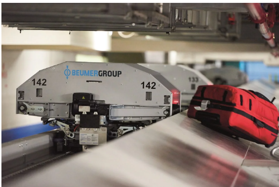
Slika 12. Automatizirano rukovanje prtljagom na zračnoj luci London Stansted Izvor: [33]
