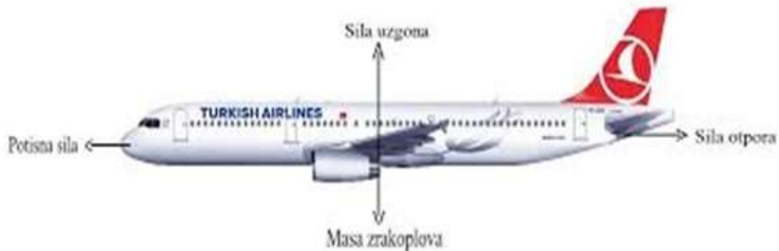
Slika 2: Sile koje djeluju na zrakoplov
