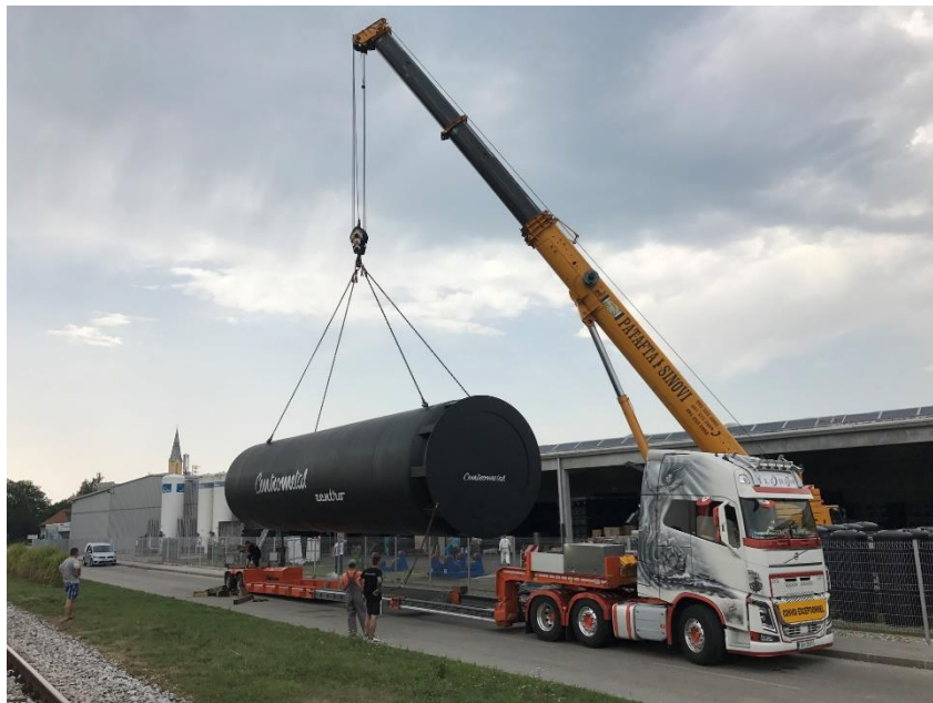
Slika 15 Utovar, centriranje i učvršćivanje tereta
