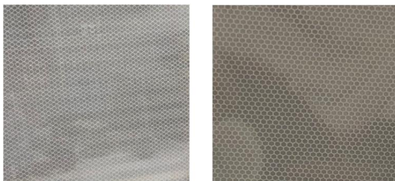
Slika 9. Folije klase IIP (lijevo) i IIS (desno)
