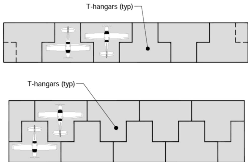
**Slika 10.** Standardni T-hangar i ugniježdeni T-hangar, [20]
