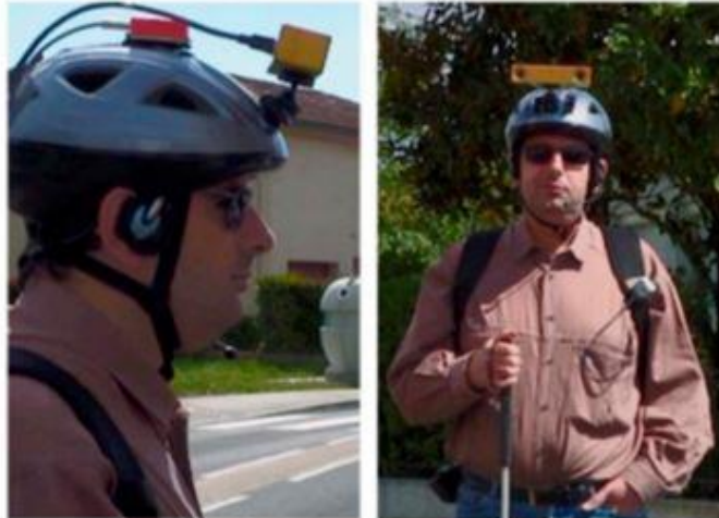
Slika 18. Pomoćni uređaj za slijepo osobe koji se temelji na pristupu usklađivanja karte i umjetnom vizijom, [37]
