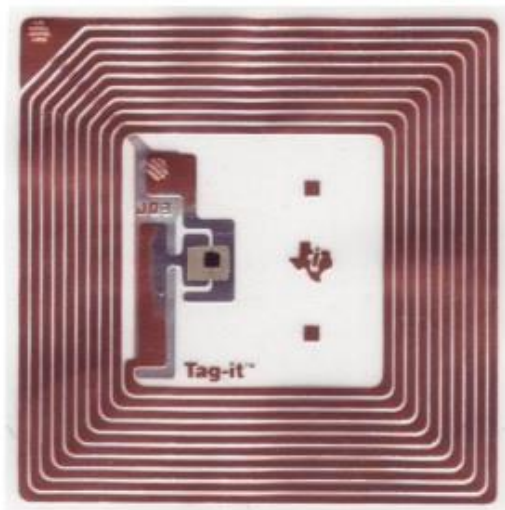
Slika 7. RFID tag – antena i mikročip, [18]
