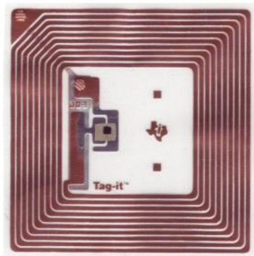
Slika 7. RFID tag – antena i mikročip, [18]
