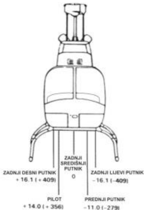
Slika 14. Udaljenost pojedinih točaka na helikopteru lijevo (-) i desno (+) od poprečne osi u in (mm) [3]
